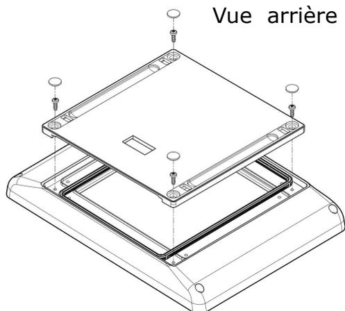
A l'arrière de l'afficheur, après avoir déposé le couvercle (ci dessus), des borniers sont accessibles pour commander des périphériques de votre choix, suivant des seuils paramétrés.
